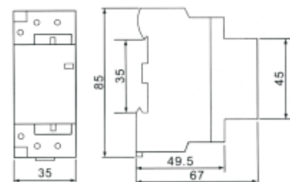
Рис. 2 Внешний вид контакторов МК-103 16-25А (04, 31, 22, 40); МК-103 32-63А (11, 20, 02)
